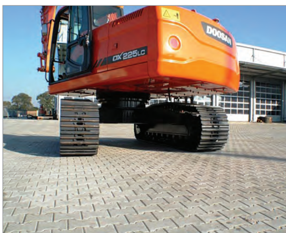
Рис. 3.8. Мощение на площадке завода производителя строительных машин и оборудования "Kraemer Baumaschinen" обеспечивает движение техники на гусеницах с грунтозацепами. Мощение выполнено в 2011 году на площади 2 000 кв.м. (фото с сайта www.korodur.de ).
