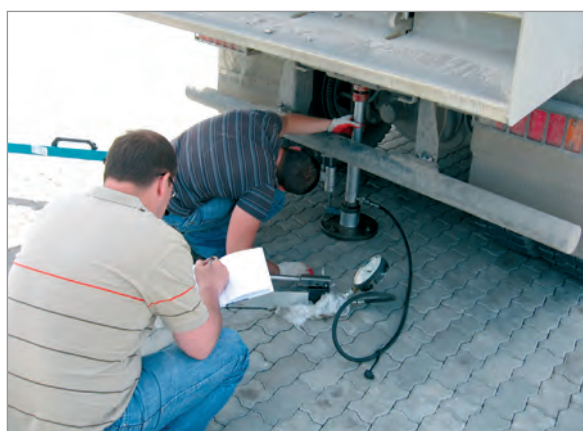
Рис. 5.7. Проведение штампового испытания.
