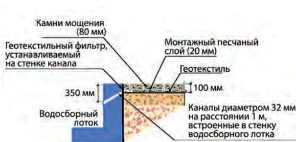
Рис. 4.3. Пример конструктивного решения водоотвода из монтажного (выравнивающего) слоя (аэропорт Гонконга).
