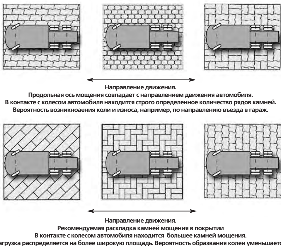
Рис. 5.2. Правильная и неправильная раскладка камней мощения в дорожном покрытии
