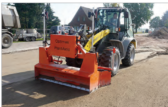
Лазерный планировщик "PlanMatic" ("Optimas")
