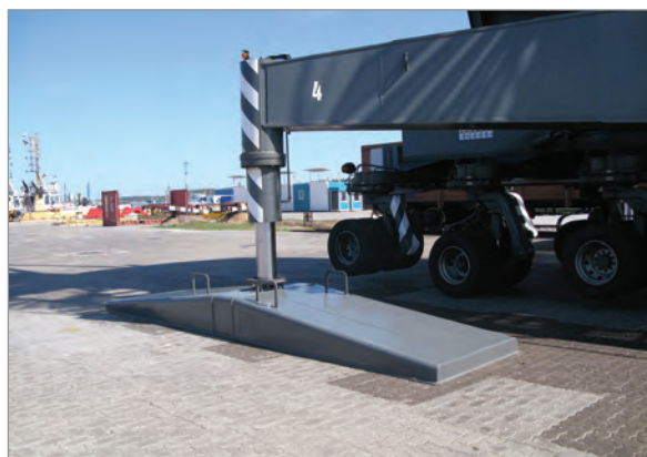
Опора крана "LIEBHERR" не вызывает деформации покрытия.
