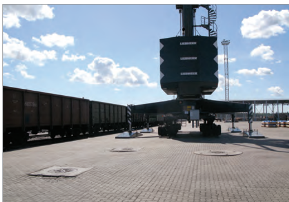
Кран "LIEBHERR" на пневмоходу (380 тонн + вес груза) передвигается вдоль ж/д путей. Колейность отсутствует.
